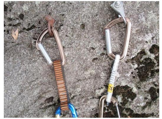
狭い幅のテープに較べると、テープ幅が広い場合は墜落などで強いテンションが掛かった場合には、カラビナのエンド部分が左右に押し広げられる割合が大きいので、それだけカラビナを横方向に押し開く力が強くなりカラビナ破断の危険性が増すと言えるので、同じ荷重強度を持つシュリングであれば幅が狭い方が強度の面では有利である。近年は幅が狭くても強度が大きいダイニーマ製のテープシュリングが販売されているので、ダイニーマ製を使えば強度の面では有利である。上の写真では、左側がナイロン製、右側がダイニーマ製であり、ダイニーマ製はナイロン製の半分ほどの幅しかないが、荷重強度はどちらも 22KN で同じである。
