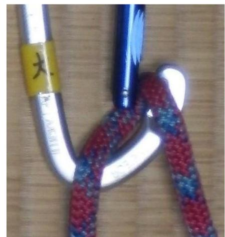
若干補足すれば、図一57はクライマー側ロープが空側に出ているということから言えば一見順クリップのように見えるが、これはやはり墜落ロープがゲートを押いてクリップが外れる虞がある。逆に図一58は一見逆クリップのように見えるが、こちらはクライマーが墜落してもゲートが開く可能性は低い。
