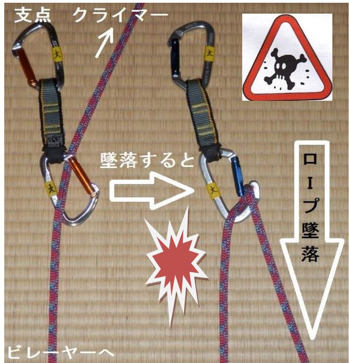
(図-56 ロープが叩いてクリップが外れる)
